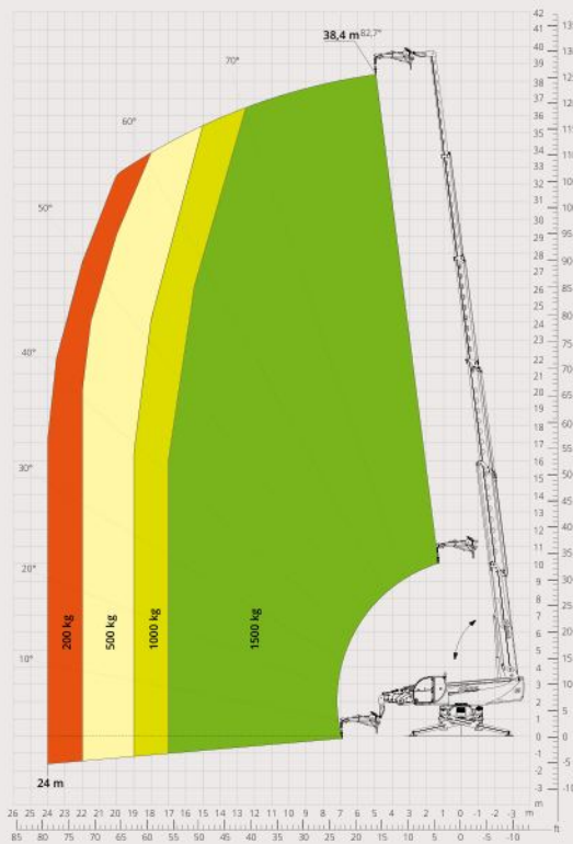
Diagram draagvermogens met GIEK MET LIER 1.500 kg
