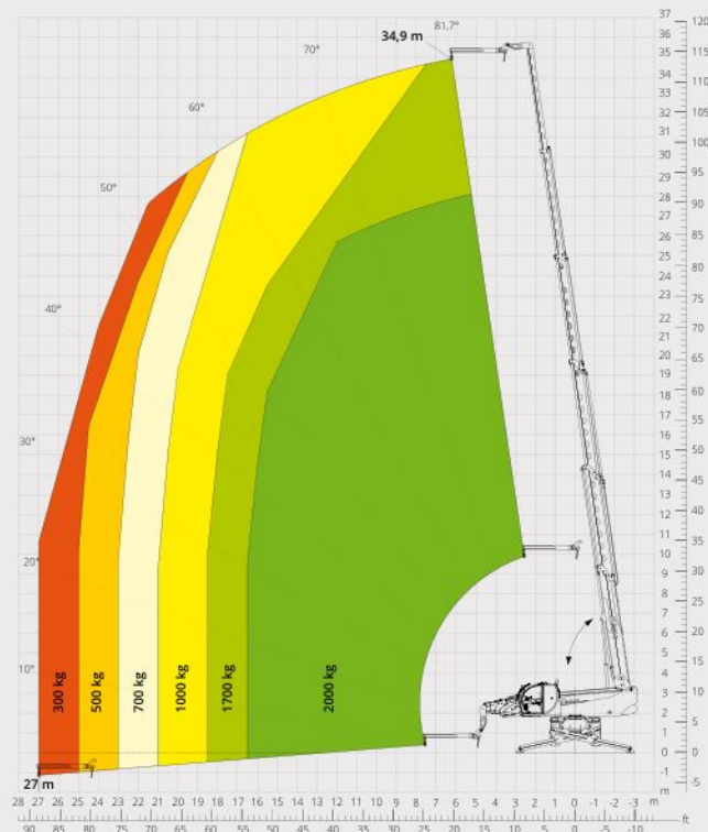
Diagram draagvermogens met GIEK 2.000 kg
